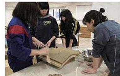
瓦1枚分の荒地（粘土板）をたたき締めながら成型
